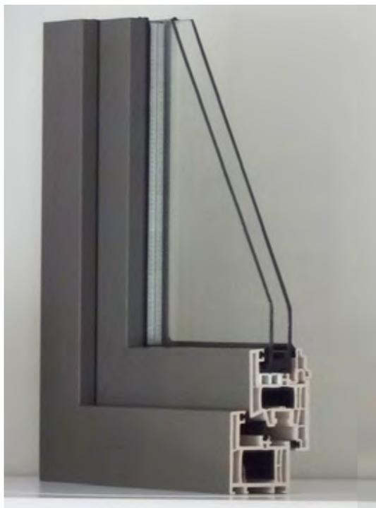
Les vitrages isolants acoustiques reposent sur le principe du double vitrage asymétrique, avec des feuilles de verre d'épaisseurs différentes.
