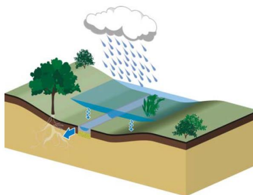
Noue infiltrante à cunette en son creux. Source: Bruxelles environnement – Guide du bâtiment durable © Architecture et Climat
