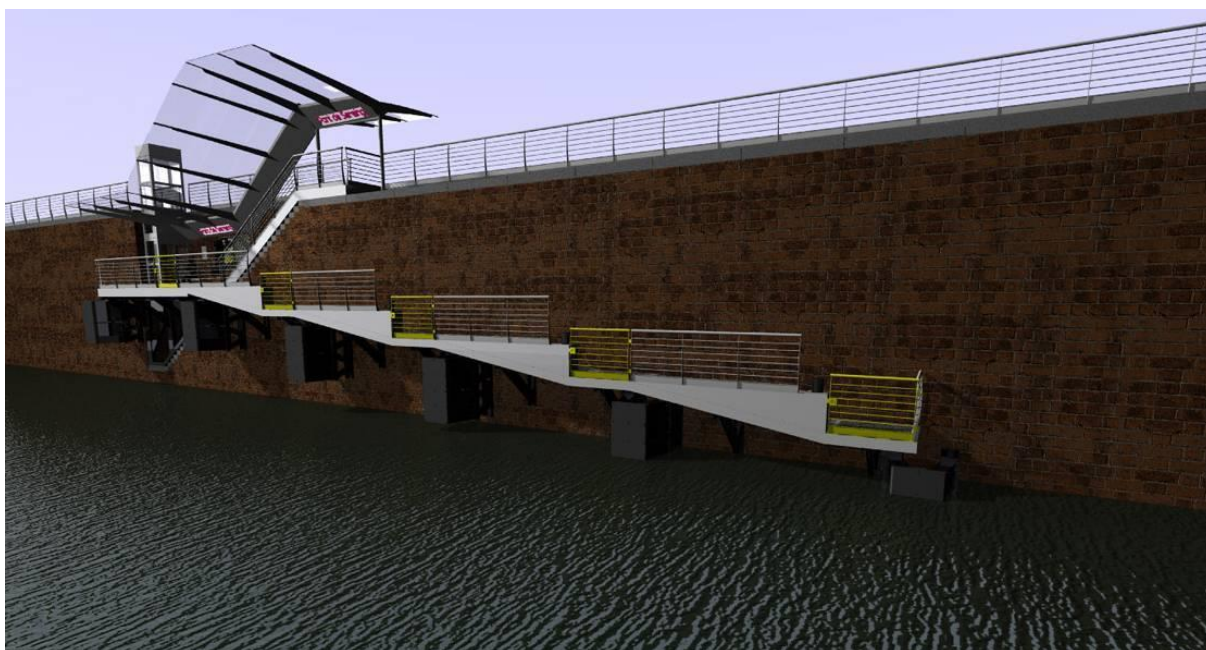
Figure 65 : Conception type d'un embarcadère avec ascenseur pour quai haut
