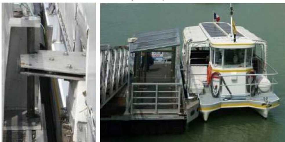
Figure 7 : Système d'accroche automatique à La Rochelle (CERTU, 2013)
